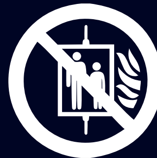
Aufzug im Brandfall nicht benutzen
